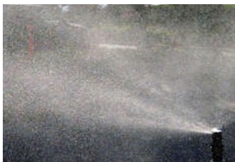
Konkurrenzdüsen mit hohem Fluss: 12H-Düse bei 3,4 bar = 62 mm/h.*
